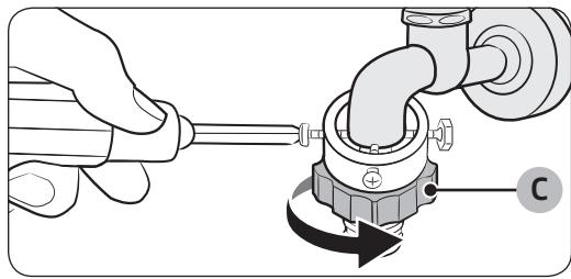
4. Inserte el adaptador en el grifo de agua y apriete los tornillos al tiempo que levanta el adaptador.
