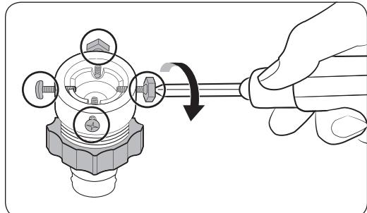
2. Utilice un destornillador Phillips para aflojar los cuatro tornillos del adaptador.
