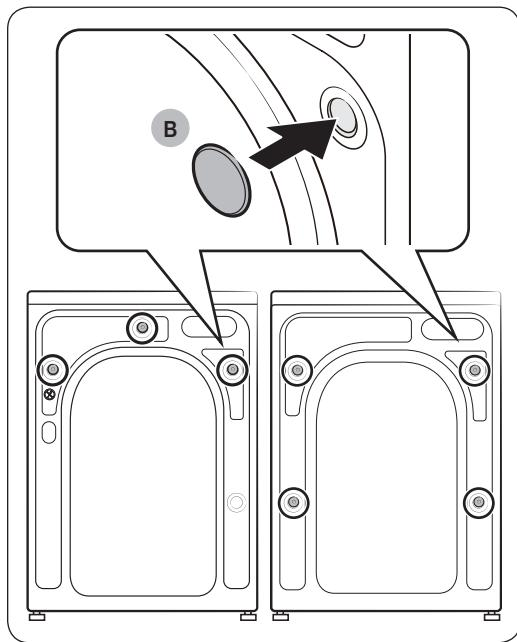
3. Inserte los **tapones de los tornillos (B)** en los agujeros (marcados con un círculo en la imagen).
