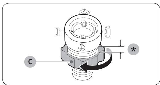
3. Sujete el adaptador y gire la **pieza (C)** en la dirección de la flecha para aflojarla 5 mm (\*).
