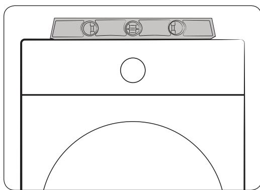
2. Nivele la lavadora ajustando manualmente las patas niveladoras.
