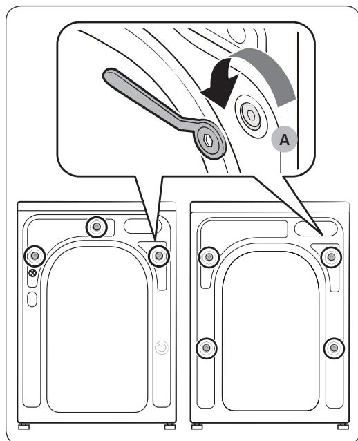
1. Coloque los tornillos de transporte (marcados con un círculo en la imagen) en la parte posterior de la lavadora.
