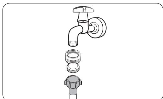
Antes de conectar la manguera de agua a un grifo, conecte la válvula de retención suministrada al grifo y, a continuación, conecte la manguera de agua.
