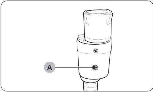
La manguera Aqua Stop alerta a los usuarios del riesgo de fugas de agua. Detecta el flujo de agua y se ilumina en rojo en el centro del **indicador (A)** en caso de fuga.
