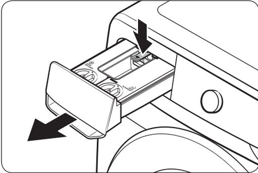
1. Sujetando la **palanca de desbloqueo** en su interior, tire de la cubeta para detergente para sacarlo.
