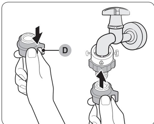
6. Mientras tira hacia abajo de la **pieza (D)** de la manguera de agua, conecte esta al adaptador. A continuación, libere la **pieza (D)**. Cuando la manguera se ajusta al adaptador se oye un clic.
