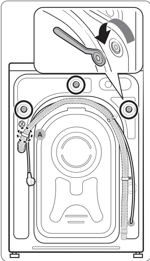
1. Coloque los tornillos de transporte (marcados con un círculo en la imagen) en la parte posterior de la lavadora.
