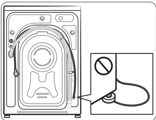
1. Coloque la lavadora en su sitio con cuidado. Si utiliza una fuerza excesiva puede dañar las patas niveladoras.
