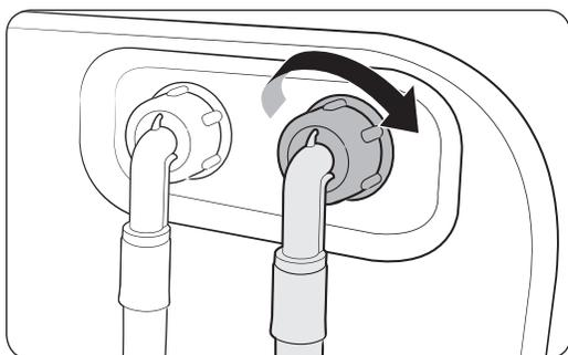
1. Conecte el extremo rojo de la manguera de agua caliente a la válvula de entrada de agua caliente situada en la parte posterior de la lavadora.
