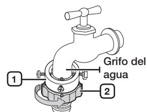
4. Conecte la manguera de suministro de agua al adaptador. Cuando la pieza (3) se libere, la manguera se conectará automáticamente al adaptador haciendo un 'clic'.
