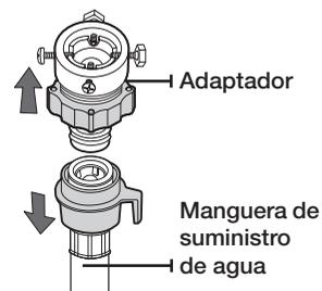
2. Primero, utilice un destornillador tipo '+' y afloje los cuatro tornillos del adaptador. A continuación, saque el adaptador y gire la pieza (2) siguiendo la flecha para dejar un espacio entre ellos de 5 mm.
