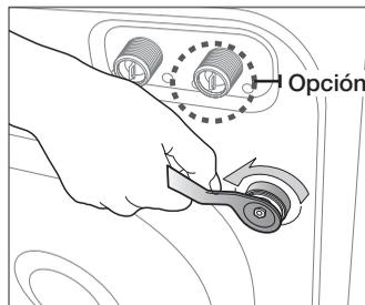
2. Sujete el tornillo con la llave y tire a través de la parte ancha del orificio. Repita el proceso para cada tornillo.
