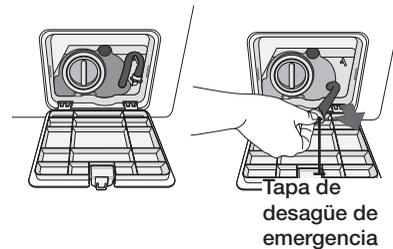
4. Sujete el tapón situado al final del tubo de desagüe de emergencia y tire hacia fuera lentamente.
