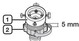
3. Conecte el adaptador a la salida de agua apretando los tornillos con fuerza mientras levanta el adaptador. Gire la pieza (2) en la dirección de la flecha y conecte (1) y (2).
