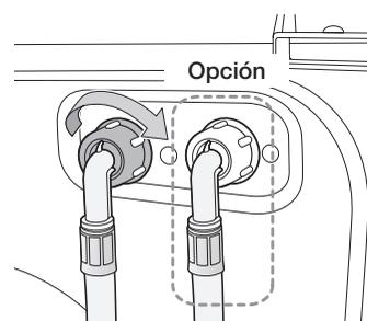
6. Abra el grifo del agua y compruebe que no haya fugas en la válvula del agua, el adaptador o el grifo. Si hubiera fugas de agua, repita el paso anterior.
