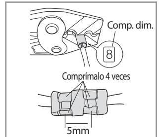
4. Envuélvalo con la cinta de aislamiento dos veces y coloque su tubo de contracción en el medio de la cinta de aislamiento.
