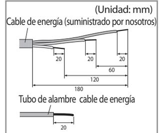
2. Inserte los dos lados del cable nuclear del cable de energía en la manga de conexión.
