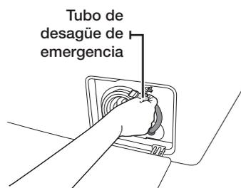
4. Desenrosque el tapón del tubo del desagüe de emergencia que cierra éste.
