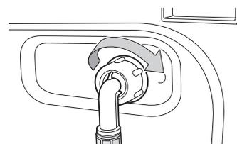
6. Abra el grifo del agua y compruebe que no haya fugas en la válvula del agua, el adaptador o el grifo. Si hubiera fugas de agua, repita el paso anterior.
