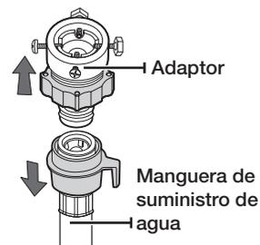
2. Primero, utilice un destornillador tipo '+' y afloje los cuatro tornillos del adaptador. A continuación, saque el adaptador y gire la pieza (2) siguiendo la flecha para dejar un espacio entre ellos de 5 mm.
