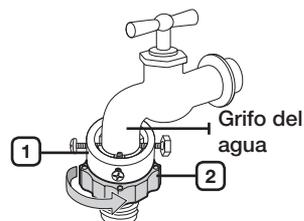
4. Conecte la manguera de suministro de agua al adaptador. Cuando la pieza (3) se libere, la manguera se conectará automáticamente al adaptador haciendo un 'clic'.
