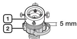
3. Conecte el adaptador al grifo de agua apretando los tornillos con fuerza mientras lo levanta. Gire la pieza (2) en la dirección de la flecha y conecte (1) y (2).
