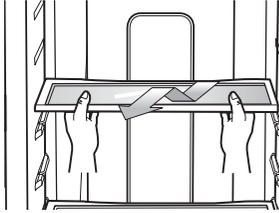
2. Retire el Cajón para frutas y verduras presionando las muescas en el interior de los lados derecho e izquierdo de la cubierta del cajón de verduras/cajón seco y retírelo tirando de él. Manteniendo el cajón con una mano, levántelo un poco al mismo tiempo que tira de él para sacarlo del frigorífico.
