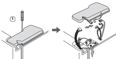
2. Retire los tornillos de la bisagra **2** y el tornillo de anclaje **3** girándolos en el sentido antihorario, y retire la bisagra superior **4**. Tenga cuidado al retirar la puerta, para que no le caiga encima.
