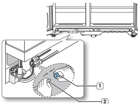
2. La tubería de agua debe estar totalmente insertada hasta el centro del acoplador transparente para evitar fugas del dispensador.
