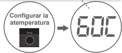
Se puede disminuir gradualmente la temperatura del agua pulsando el botón **Temp.** de la temperatura máxima al agua fría (--).
