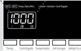
Pulsando el botón selector de velocidad, podrá modificar las revoluciones, de forma gradual, desde la cancelación del centrifugado (--) y hasta la velocidad máxima para el programa seleccionado.
