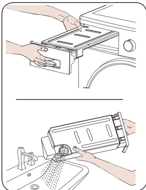
1. Tire de la tapa del cajón y extraiga con cuidado el depósito.
