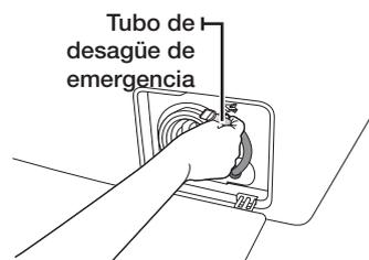
4. Desenrosque el tapón del tubo del desagüe de emergencia que cierra éste.
