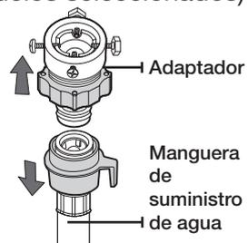
2. Primero afloje los cuatro tornillos del adaptador con un destornillador tipo '+'. Luego, tome el adaptador y gire la pieza (2) siguiendo la flecha hasta dejar un espacio de 5 mm entre ellos.
