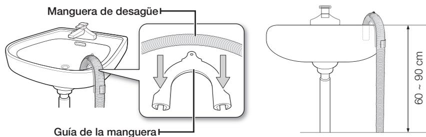
2. **En un brazo de la tubería de desagüe del fregadero:** El brazo de la tubería de desagüe debe estar situado por encima del sifón del fregadero a fin de que el extremo de la manguera quede al menos a 60 cm del suelo.
