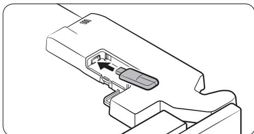
3. Inserte el Smart Home Adapter en el puerto del adaptador siguiendo la dirección correcta.
