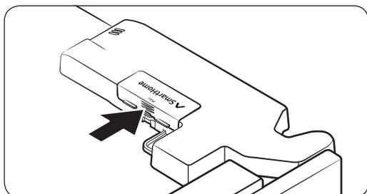
1. Presione para desbloquear la zona de la flecha de la tapa del adaptador.
