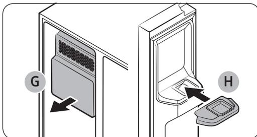
Si no utiliza la máquina de hielo y necesita más espacio de almacenamiento, quite el depósito de la máquina de hielo (G). Después, inserte la guía del congelador (opcional) (H) en el conducto de hielo.
