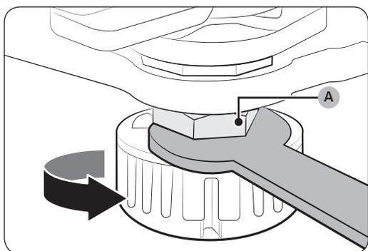
1. Abra la puerta que desea ajustar y localice las dos tuercas (A) y (B) en la parte inferior delantera.
