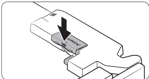
4. Inserte primero la parte superior de la tapa del adaptador y luego presione para cerrarlo como se muestra.
