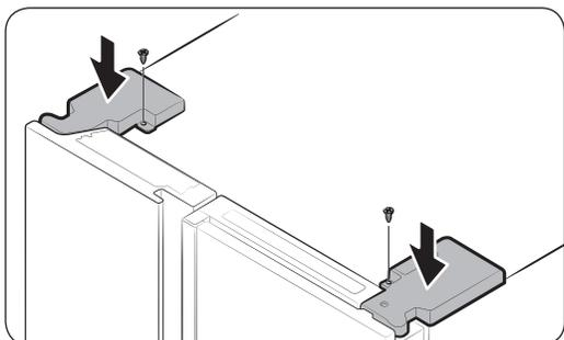
6. Inserte las tapas de las bisagras con el lado frontal en primer lugar y luego apriete los tornillos. Utilice un destornillador Phillips para este procedimiento.
