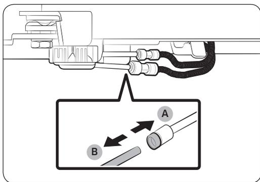
2. Para desconectar las mangueras, mantenga presionado el **acoplador transparente (A)** y desmonte la **manguera de agua (B)**.
