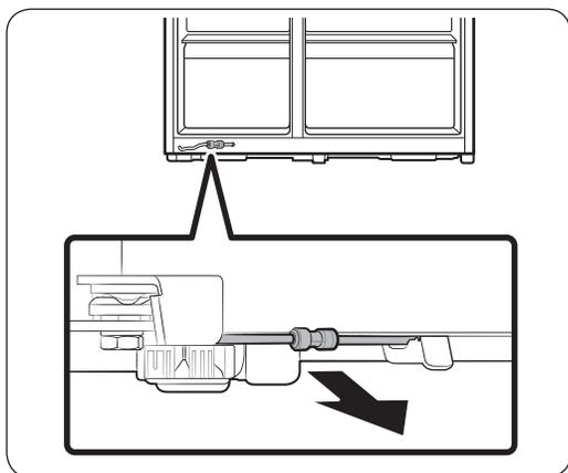
1. En la parte inferior posterior del frigorífico, extraiga la tubería de agua hacia el frente.
