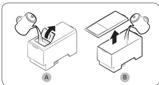
2. Abra la **tapa frontal (A)** de la cubierta o la **cubierta entera (B)** y llene el depósito con un máximo de 5 litros de agua.
