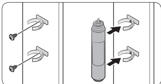
1. Monte las **grapas de sujeción** (x2) en el lugar apropiado, por ejemplo debajo del fregadero. A continuación, fije firmemente las **grapas de sujeción** con tornillos.
