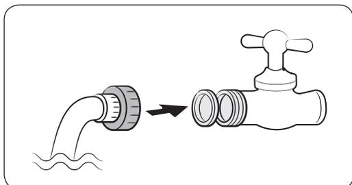
1. Monte la tubería de agua con los acopladores.
