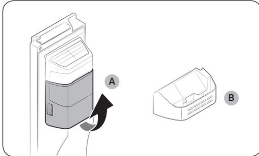
Si no utiliza la máquina de hielo y necesita más espacio de almacenamiento, quite el depósito de la máquina de hielo (A) y la máquina de hielo. Después inserte la Guía del congelador (opcional) (B) en el lugar del depósito de la máquina de hielo.
