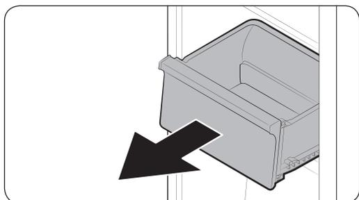
Levante con cuidado la parte frontal del cajón y deslícelo hacia afuera.
