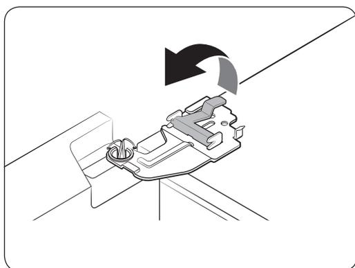
1. Utilice un destornillador Phillips para aflojar las **tapas de las bisagras (A)** de la parte superior de cada puerta.
