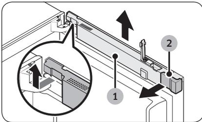
3. Levante la cubierta del cable (1) y gire 90 grados hacia adelante para extraerla. Después quite la cubierta del espacio (2).
