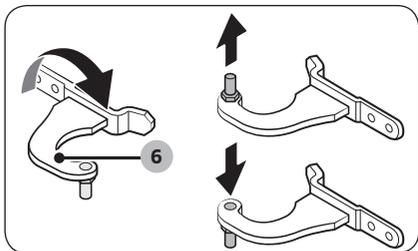
5. Retire el eje de la **bisagra superior (6)**. Vuelva a montar el eje como se muestra.
