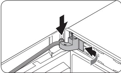
8. Inserte la cubierta de la bisagra en la bisagra superior, primero por el lado derecho. Después presione la parte inferior de la cubierta para encajarla.
