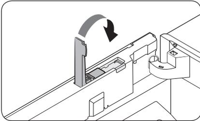
10. Con la tapa del dongle abierta, inserte la cubierta del cable (1) y gírela hacia atrás. Inserte la cubierta del espacio (L) y cierre la cubierta del cable.
