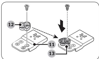
3. Use una llave de 11 mm para quitar el **eje de la bisagra (12)** de la **bisagra inferior (11)**. A continuación inserte la **protección de cierre automático (13)** como se muestra.
