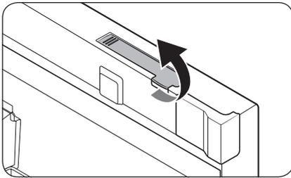
2. Abra la puerta del frigorífico y tire hacia arriba para abrir la tapa del dongle que se encuentra en la parte superior de la puerta.
