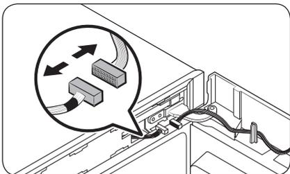
6. Desconecte los conectores que se encuentran alrededor o en la puerta del frigorífico. Afloje los tornillos de la **bisagra superior (6)** y retírelos.
