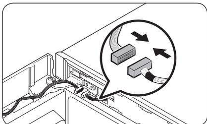
7. Conecte los conectores de la puerta del refrigerador y la unidad principal. Fije los cables en el gancho interior de la cubierta de la bisagra (L) opcional.
