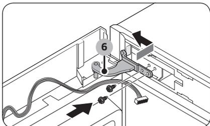
6. Inserte la **bisagra superior (6)** en la parte superior izquierda de la puerta del refrigerador, primero por su lado más corto. Encaje la puerta del refrigerador insertando la bisagra superior y después la bisagra central. A continuación, apriete los tornillos de la bisagra superior.
