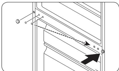
1. Utilice un destornillador de punta plana para quitar la **tapa del tornillo**. Después inserte la **tapa del tornillo** en el lado opuesto.
