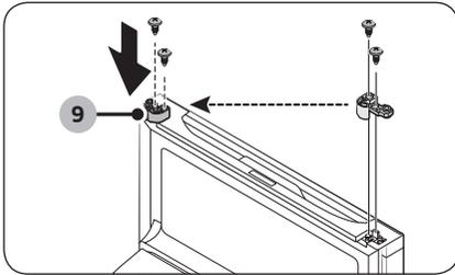
1. En la puerta del frigorífico, retire la **palanca de cierre automático (9)** aflojando los tornillos de la palanca y los del lado opuesto.
