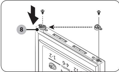
1. En la puerta del congelador, retire la **palanca de cierre automático (8)** aflojando los tornillos de la palanca y los del lado opuesto.
