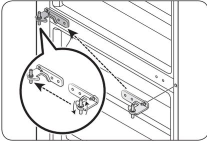
6. Vuelva a insertar la bisagra central (7) que retiró en el PASO 2.
