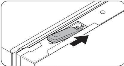
2. Inserte el Smart Home Dongle en el puerto para dongle siguiendo la dirección correcta.
