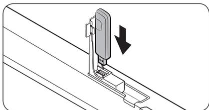
1. Abra la puerta del frigorífico y tire hacia arriba para abrir la tapa del dongle que se encuentra en la parte superior de la puerta.
