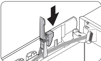
4. Vuelva a montar la tapa del dongle en la posición original.
