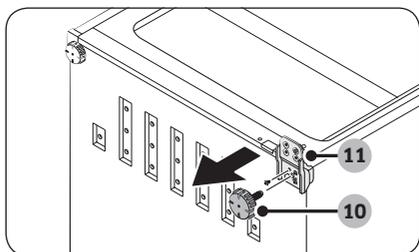
2. Coloque el frigorífico sobre el suelo con cuidado. Retire los tornillos de la **pata de ajuste (10)** y la **bisagra inferior (11)**.
