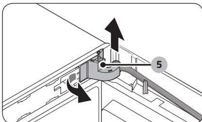
5. Tire del lado izquierdo de la **cubierta de la bisagra (5)** y levante ligeramente la parte inferior para extraerla.
