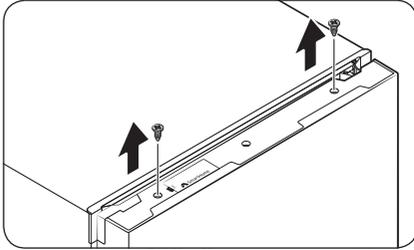
1. Con la puerta del frigorífico cerrada, afloje y quite dos tornillos de la parte superior de la puerta. (RB37 solo modelos con puerta de cristal)
