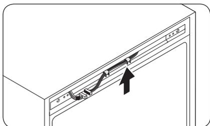
2. Desplace los conectores y los cables al lado opuesto. Inserte la **cubierta de los controles (14)** y apriete los tornillos en el lado opuesto.
