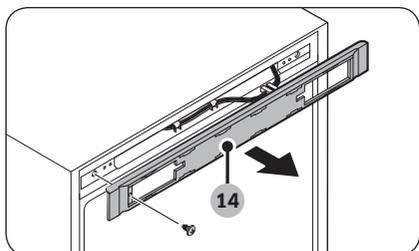
1. Afloje y quite los tornillos superiores del frigorífico. A continuación retire la **cubierta de los controles (14)**.
