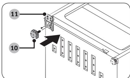
4. Inserte la **bisagra inferior (11)** en el lado opuesto. A continuación, instale la **pata de ajuste (10)**.
