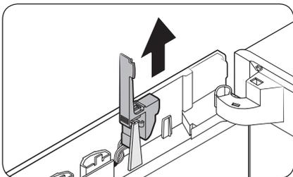
3. Tire hacia arriba para abrir la tapa del dongle que se encuentra en la parte superior de la puerta del frigorífico.
