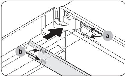
9. Inserte la cubierta del marco superior (4) con la parte (b) encajando en la parte (a) en diagonal. Luego deslice el extremo de la cubierta hacia la izquierda para bloquearla.
