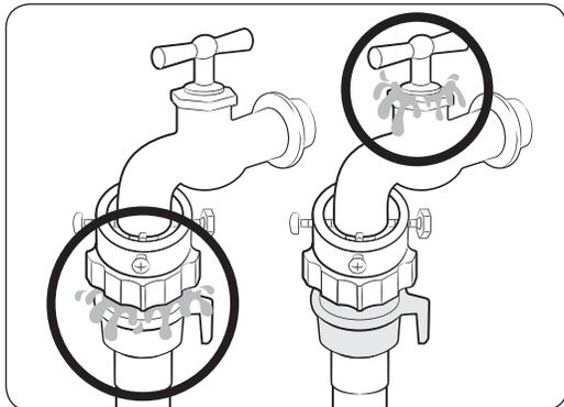
9. Abra el grifo del agua y asegúrese de que no hay fugas en las conexiones. Si hubiera fugas de agua, repita los pasos anteriores.
