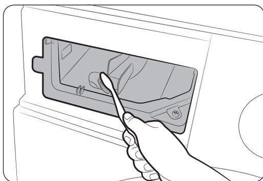
1. Abra la cubeta sujetando la **palanca de desbloqueo (A)** en su interior.
