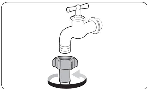
3. Sujete el adaptador y gire la **pieza (C)** en la dirección de la flecha para aflojarla 5 mm (\*).
