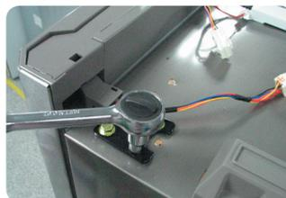
4. Démontez la porte du réfrigérateur en la soulevant. Veillez à ne pas laisser tomber la porte du réfrigérateur ni à rayer sa partie avant.
