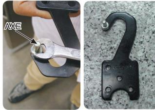
9-1. Après avoir joint la charnière (COVER WIRE HINGE) gauche et l'ensemble charnière supérieur (ASSY HINGE UPP), basculez la position de la charnière à œillet (GROMMET HINGE) et le CAP SPACE DOOR.
