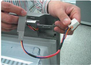
8. A l'aide de la clé 11 mm, séparez l'AXE DE LA CHARNIERE, faites basculer la CHARNIERE et fixez à nouveau l'AXE DE LA CHARNIERE.
