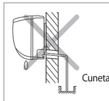
No coloque el extremo de la manguera de desagüe en un hueco.
