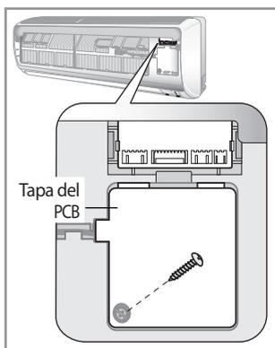
4. Encuentre el cable del PCB, y conecte el cable al Sub PCB como se indica en la imagen.
