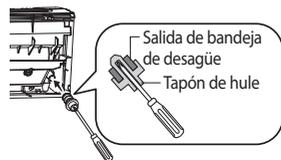
Vierta el agua en dirección de la flecha. \* Dirección del agua drenada
