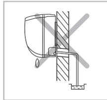
El extremo de la manguera de desagüe NO debe colocarse bajo el agua.
