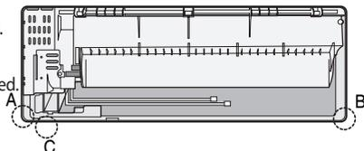
1. Corte el agujero ciego apropiado (A, B, C) en la parte posterior de la unidad de interior a menos que conecte la tubería directamente de la parte posterior.
