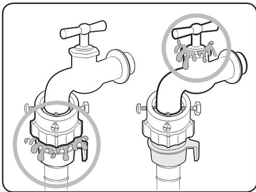
9. Abra el grifo del agua y compruebe si hay fugas alrededor de las áreas de conexión. Si las hay, repita los pasos anteriores.
