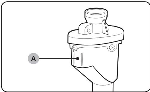
El Aqua Hose alerta a los usuarios del riesgo de que se produzcan fugas de agua. Detecta el flujo de agua y, en caso de fuga, el **indicador (A)** central se vuelve de color rojo.
