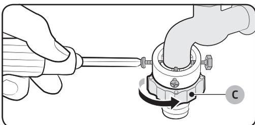
4. Inserte el adaptador en el grifo del agua y apriete los tornillos al mismo tiempo que levanta el adaptador.
