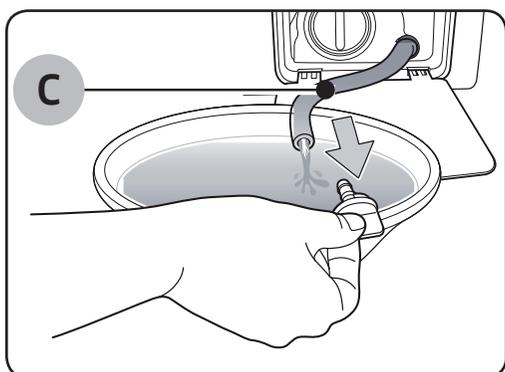
4. Abra la tapa del tubo y deje que el agua en el **tubo de drenaje de Emergencia (C)** fluya hacia el recipiente.
