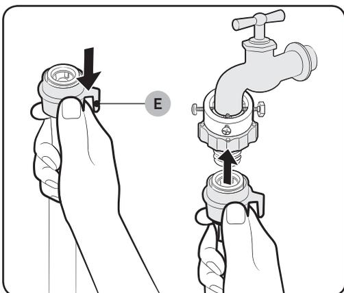
6. Mientras sujeta la **pieza (E)**, conecte la manguera de suministro de agua al adaptador. A continuación, suelte la **pieza (E)**. Al encajar la manguera en el adaptador se escucha un clic.
