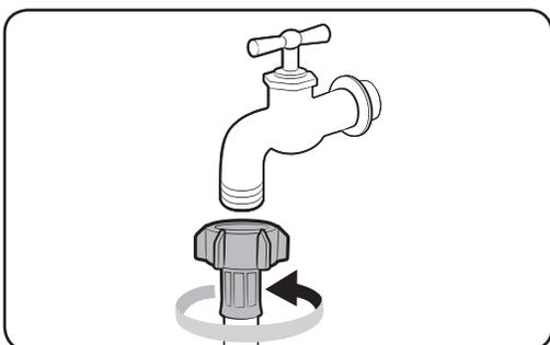
7. Si está utilizando un grifo tipo tornillo, emplee el adaptador tipo tornillo para conectar al grifo tal y como se muestra.
