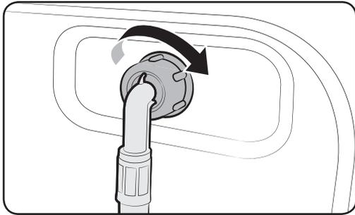
8. Conecte el otro extremo de la manguera de suministro de agua a la válvula de entrada situada en la parte posterior de la lavadora. Gire la manguera en el sentido de las agujas del reloj para apretarla.
