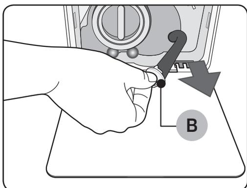
3. Coloque un recipiente vacío, espacioso sobre la cubierta y estire el tubo de drenaje de emergencia hacia el recipiente mientras sostiene la **tapa del tubo (B)**.
