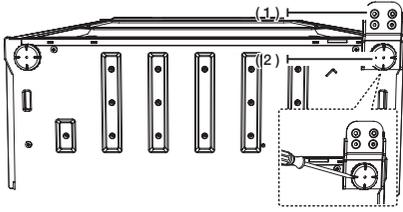
8. Retire el tornillo (1) de la parte inferior derecha de la puerta del frigorífico y del congelador.
