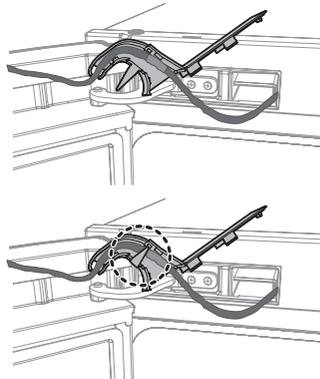
15. Ensamble la cubierta de la bisagra.
