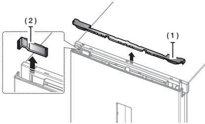
2. Retire la cubierta de la bisagra para presionar la pestaña como se muestra a continuación.
