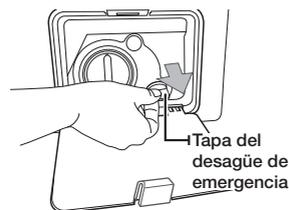
4. Sujete el tapón del extremo del tubo de desagüe de emergencia y tire hacia fuera lentamente hasta que el tubo salga unos 15 cm.
