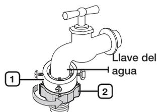
4. Conecte la manguera de suministro de agua al adaptador. Cuando libera la pieza (3) la manguera se conecta automáticamente al adaptador haciendo un 'clic'.
