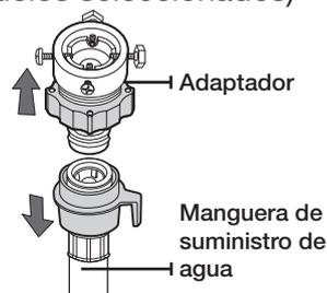
2. Primero afloje los cuatro tornillos del adaptador con un destornillador tipo '+'. Luego, tome el adaptador y gire la pieza (2) siguiendo la flecha hasta dejar un espacio de 5 mm entre ellos.
