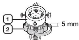
3. Conecte el adaptador a la salida de agua ajustando los tornillos con fuerza mientras levanta el adaptador. Gire la pieza (2) en el sentido de la flecha y conecte (1) y (2).
