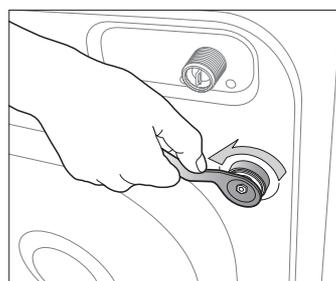
2. Ajuste el tornillo con la llave y hágalo atravesar la parte más amplia del orificio. Repita el proceso para cada tornillo.
