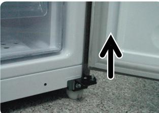
13. Después de retirar los 2 tornillos, desmonte la TAPA FRONTAL DE LAS PATAS.
