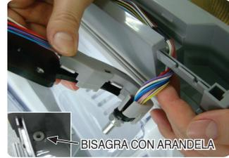
9-2. Al desmontar el TAPÓN SEPARADOR, no empuje los enganches de ambos lados, sino el enganche inferior como se muestra.
