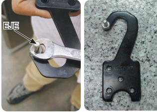
9-1. Tras volver a unir la VISAGRA L y el MÓDULO DE BISAGRA SUPERIOR, cambie la posición de la ARANDELA DE LA BISAGRA y el SEPARADOR DE LA PUERTA.
